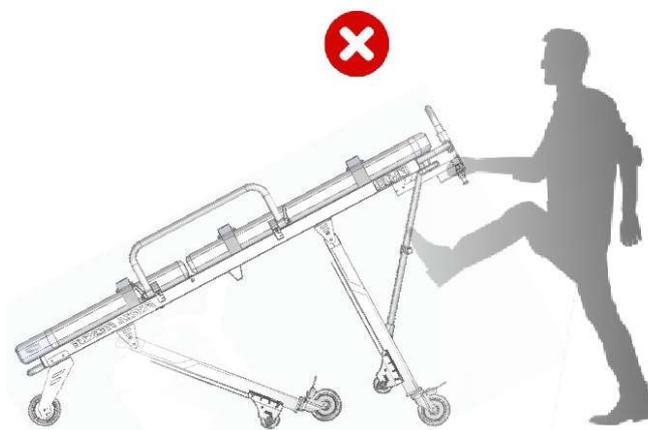
1) Após a colocação do paciente sobre a maca inicie o traslado até a ambulância. Para a maca biarticulada modelo FR-B1 o processo de entrada na ambulância ocorre em duas etapas: **1:** Encoste os batentes dianteiros de maneira uniforme no para-choques da ambulância **(A)** e acione a alavanca de retração esquerda **(B)** até dobrar os joelhos dianteiros, empurrando a maca para dentro da ambulância **(C)**.
