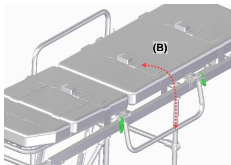
3) Cabeceira móvel: Acione a alavanca **(A)**, levantando ou baixando a cabeceira no ângulo desejado **(B)**, soltando a alavanca e deixando com que ela trave automaticamente em uma das posições de altura.
