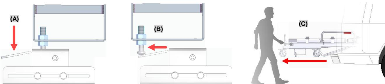
**ATENÇÃO:** Fique atento quando a ambulância estiver estacionada em terrenos íngremes ou irregulares. Poderá ser necessária a inclinação da maca para compensação de nivelamento e total abertura do conjunto de articulação. Ao puxar a maca para fora da ambulância solte a alavanca de retração e verifique se o conjunto de articulação foi armado corretamente.
