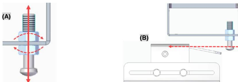
**ATENÇÃO:** Verifique regularmente o ajuste e fixação da maca. Com o passar do tempo, devido ao uso, a mesma pode se deslocar levemente do sistema, comprometendo sua fixação. Este ajuste também deve ser feito no caso de substituição da maca ou adaptação de maca reserva.
